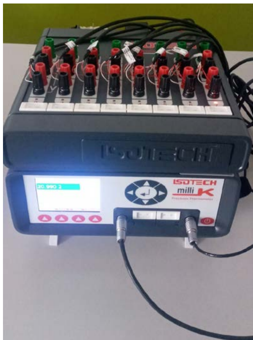
Рис. 2. Зовнішній вигляд калібрувального комплексу на базі прецизійного термометра milliK та розташування датчиків у корисному об'ємі сушильної шафи
