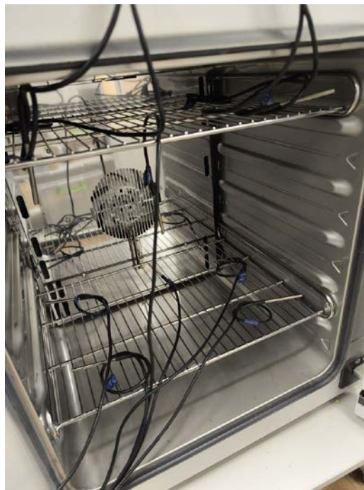
Рис. 2. Зовнішній вигляд калібрувального комплексу на базі прецизійного термометра milliK та розташування датчиків у корисному об'ємі сушильної шафи
